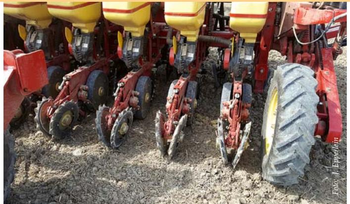
Pneumatische Einzelkornsägggregate an der Gherardi Einzelkorn-Direktsaatmaschine.
